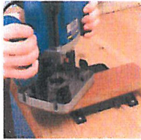
Maintien de petites ou moyennes pièces sur le plateau à sections divisibles. Plateau en travail vertical
