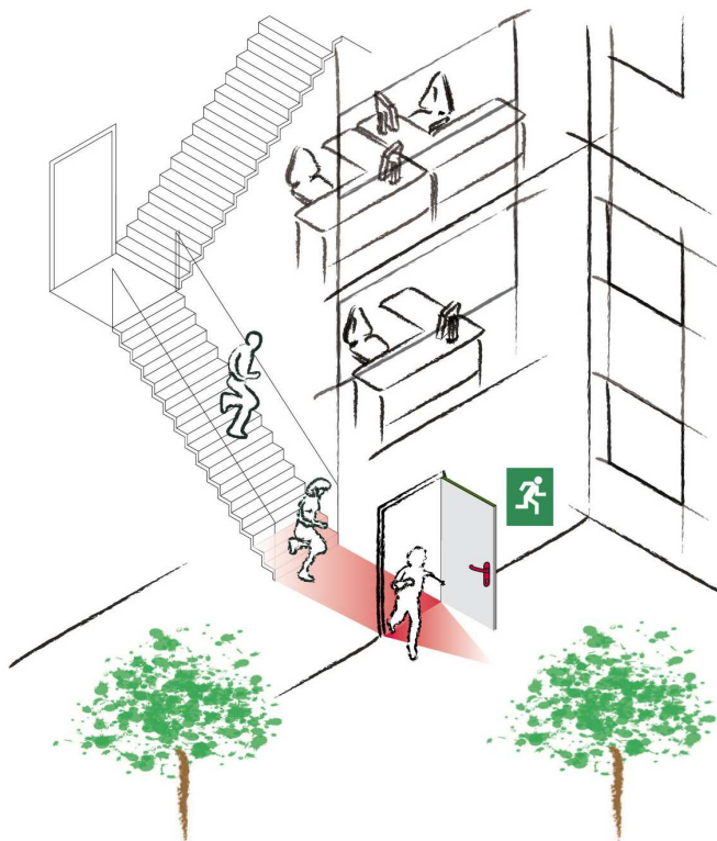
Ferrure pour portes d'issue de secours selon DIN EN 179
