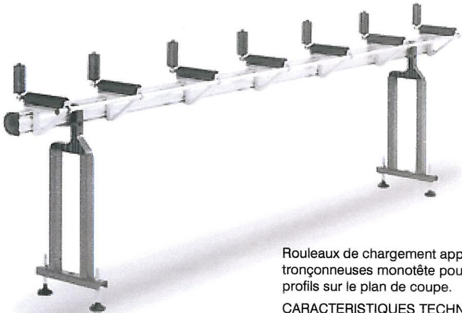
Rouleaux de chargement applicables à toutes les tronçonneuses monotête pour l'appui et le glissement des profils sur le plan de coupe.
