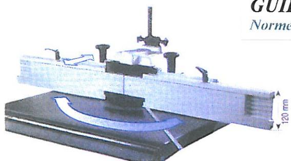
Le guise continu de sécurité Bimaq. ce guide repose sur un principe simple : il s'adapte à la forme de l'outil et permet un appui continu de la pièce durant l'usinage. Les risques de basculement sont éliminés, les risques de rejets réduits et les irrégularités de moulure éliminés.
