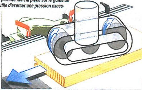
Solution idéale pour travailler sans crainte d'accident. L'avance du bois est pris en charge totalement par la machine.
