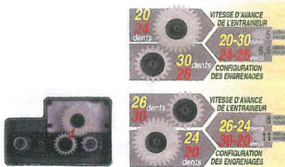
Réglage mécanique de la vitesse d'avance 2 jeux de pignons 20/30 dents et 24/26 dents permettent, en les inversant, d'obtenir 4 vitesses différentes : 5 - 6,5 - 8 & 11 m / mn. Une solution simple, assurant une puissance constante et ayant largement fait ses preuves.
