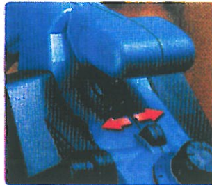
Manette de sélection pour l'évacuation canalisée des copeaux à droite ou à gauche.
