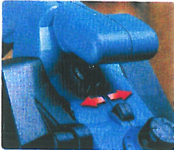
Manette de sélection pour évacuation canalisée des copeaux à droite ou à gauche.
