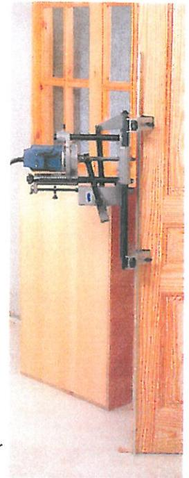
La FC 16 S est pourvue d'une règle butée se fixant sur la machine, permettant un réglage soit par rapport au sol, soit par rapport au dessus de la porte. Cette possibilité permet de travailler toujours à la même hauteur pour des usinages identiques
