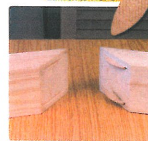
Assemblage robuste avec les lamelles n°6
