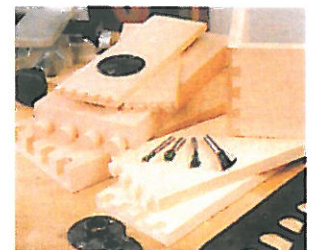
4 types de queue d'aronde pour un assemblage parfait
