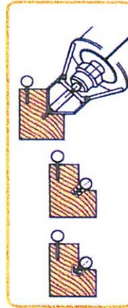
En utilisant le guide à 90° : rainures obliques à 45°
