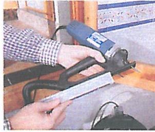
Fournie avec 2 guides interchangeables permettant la réalisation de rainures obliques à 45° ou droites et une mèche ancre double pointe carbure
