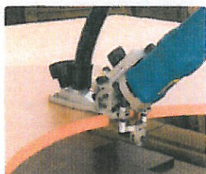
Palpeur à roulement pour un guidage parfait des chants courbes ou droits.
