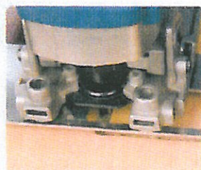
Douille de copiage en utilisation de aëfonçage.
