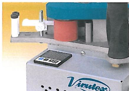
Réglage électronique de la température de la colle
