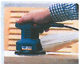
En rotorbitale, combine deux mouvements: rotatif et vibrant.
