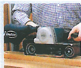
Modèle LB31EA avec aspirateur de poussière intégré.
