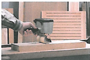
Rouleau inférieur en mousse pour colles blanches. Encollage avec des colles vinylique.
