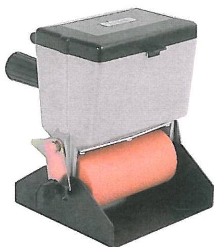
Rouleau inférieur en mousse pour colles blanches. Encollage avec des colles vinylique.
